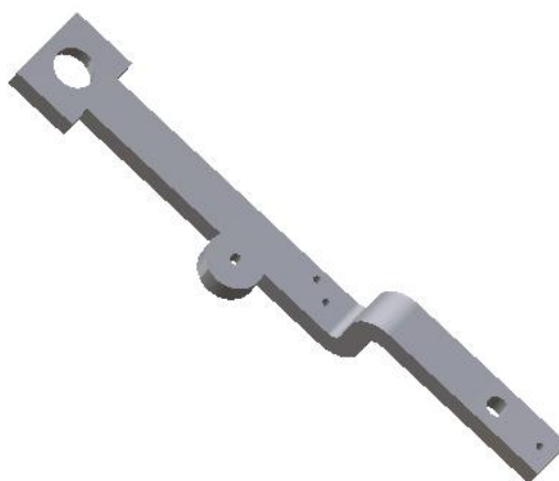
(32)Barre de chassis coté droit Matériau : Alliage d'aluminium EN-AW 6106 Usinage : Tournage, Fraisage, Percage traversant
