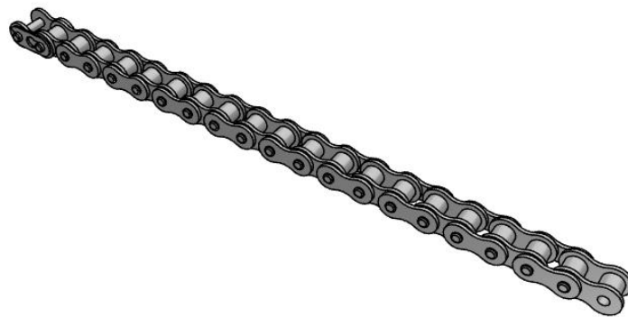
(2) Chaîne Caractéristiques : nombre de maillons = 46, Pas = 12.7mm, Nombre nominal = 40 Matériau : Acier
