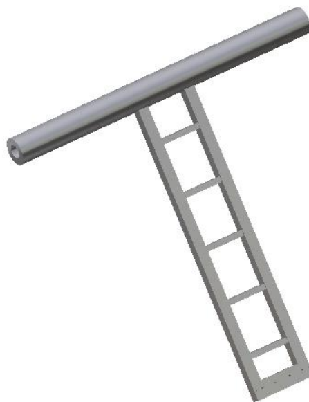
(19) Barre de poussée Partie 1 Matériau : Alliage d'aluminium EN-AW 6106 Usinage : Tournage, Fraisage, Percage traversant
