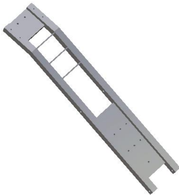
(20) Barre de poussée Partie 2 Matériau : Alliage d'aluminium EN-AW 6106 Usinage : Tournage, Fraisage, Percage traversant
