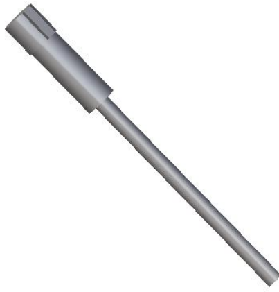
(17) Barre de liaison engrenage-disque Matériau : Alliage d'aluminium EN-AW 6106 Usinage : Tournage, Fraisage, Percage traversant
